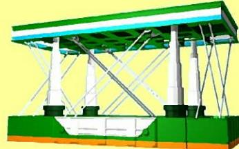
④道路上簡易ベント(多軸式特殊台車+大型ジャッキリフト併用)架設
